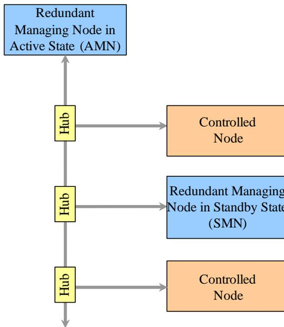
Fig. 5. MN redundancy
